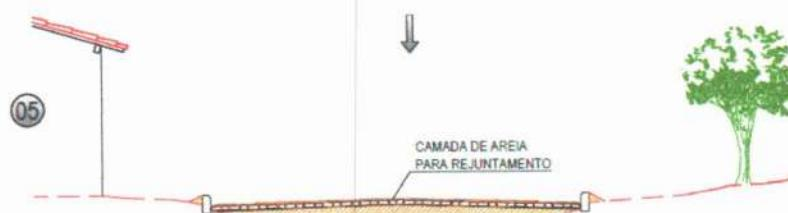
ANTES DA COMPRESSÃO COM O ROLO METÁLICO, JOGA-SE AREIA SOBRE O CALÇAMENTO, NA QUANTIDADE SUFICIENTE PARA PREENCHER AS JUNTAS E FORMAR UMA CAMADA SOBRE O CALÇAMENTO DE APROXIMADAMENTE 2CM.
